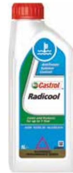
Castrol Radicool es un refrigerante para motor concentrado de uso en motores gasolina y diésel de Aluminio ó Hierro fundido. Este refrigerante puede ser mezclado con agua des-ionizada utilizando un 33% de concentración ofreciendo protección frente a la congelación hasta -18°C, de cualquier manera, se recomienda emplear un 50% de dilución para proporcionar una óptima protección frente a la corrosión y la congelación hasta -36°C.
